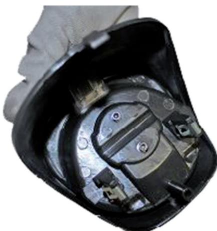
**D** Die Bohrungen der zuvor entfernten Schrauben mit den Bohrungen der Halterung fluchten.
