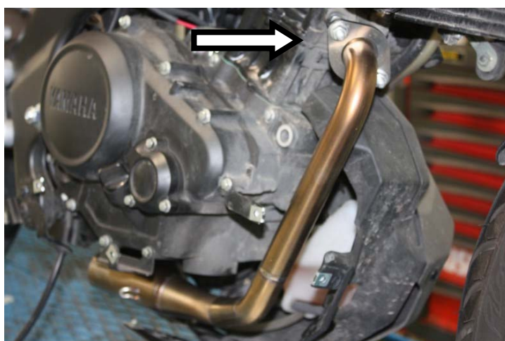
Innestare il collettore al cilindro e serrare senza stringere definitivamente la flangia ai prigionieri mediante bulloneria originale. Fit Arrow collector and secure the flange using OE bolts, do not tighten the bolts in this phase.
