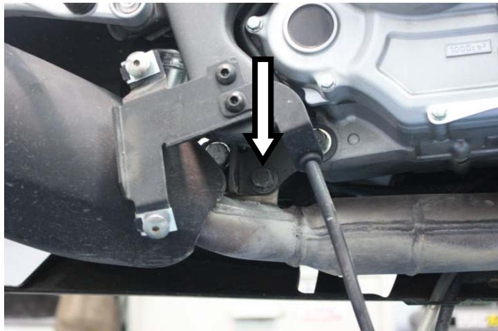
**IT** · Svitare la vite indicata e rimuovere l'impianto di scarico originale
