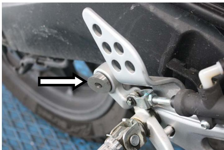
**IT** · Solo per terminali Thunder: sostituire nella pedana il bussolotto originale con quello fornito
