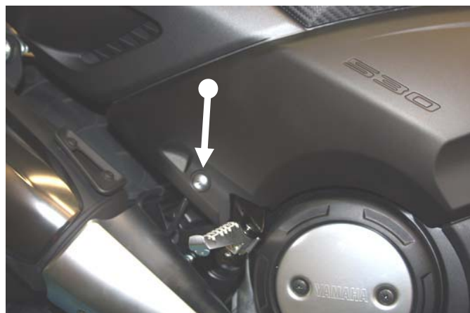
Svitare le viti indicate e rimuovere la carenatura Unscrews the screws shown above and remove the fairing
