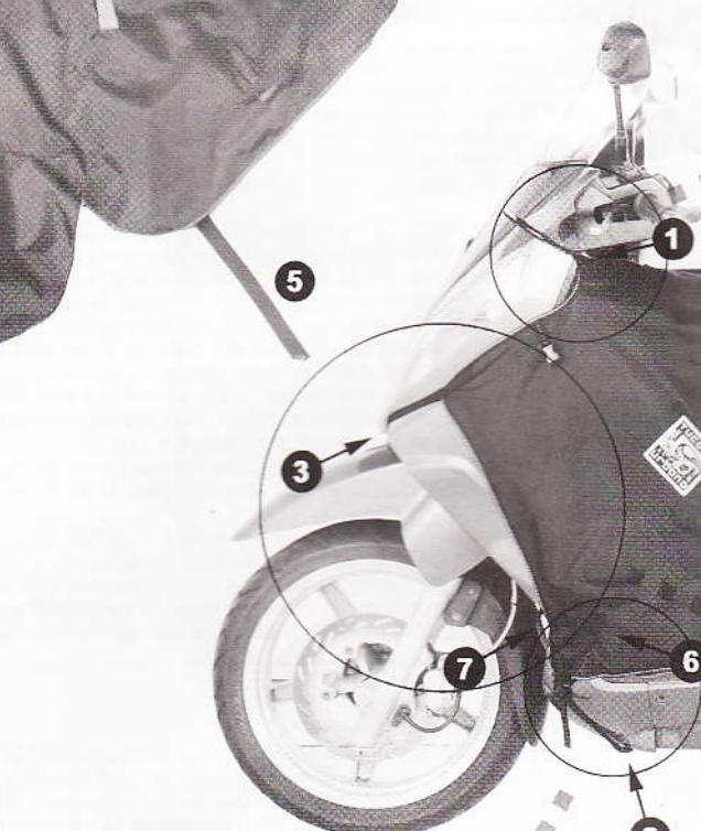
**Fixer Termoscud®** sur les deux côtés, à l'aide des vis du scooter et les faire passer dans les trous pratiqués sur les **sangles 1**.
