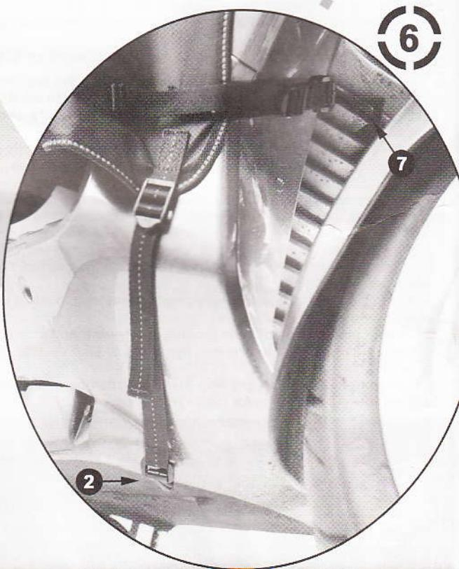
① - Fissare Termoscud® da entrambi i lati, utilizzando le stesse viti dello scooter, facendole passare **attraverso i fori sui nastri** 1.
