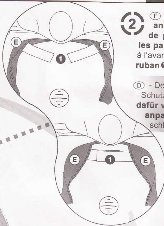
**2** (F) - Faire **coïncider les angles supérieurs du bouclier de protection du scooter avec les parties prévues (E) et fermer à l'avant la patte auto-agrippante du ruban 1.**
