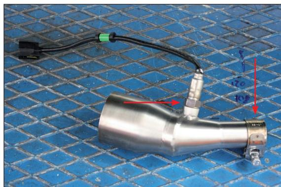
Alloggiare la fascetta nell'innesto del raccordo ed avvitare la sonda lambda
