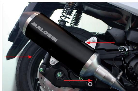
Innestare il terminale e serrare gli attacchi (2) al telaio
