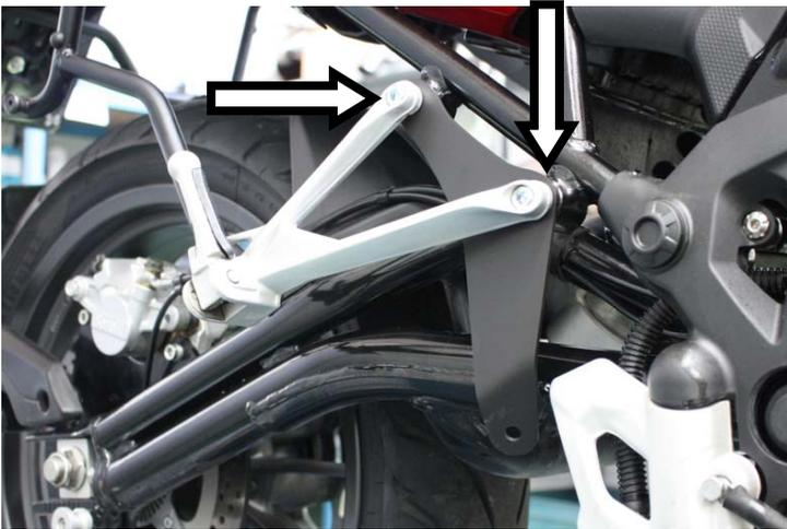
**IT** · Avvitare tra pedana e telaio la staffa di sostegno terminale
