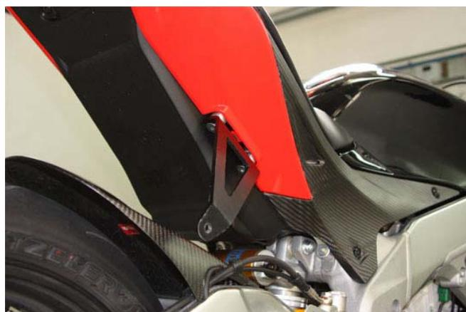
Togliere la placchetta di plastica sotto il codone e montare la staffa di sostegno del terminale ARROW
