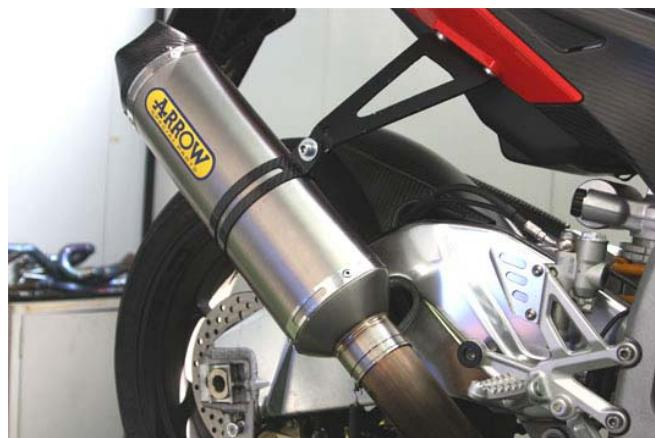
Innestare il silenziatore nel raccordo e fissarlo con l'apposita fascetta alla staffa e con la molla al raccordo, dopo aver trovato la corretta posizione.
